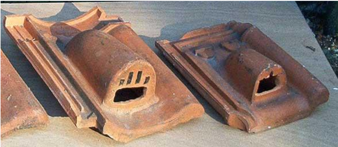
Uitgezaagde ventilatiepannen: OVH en Tuile du Nord.
