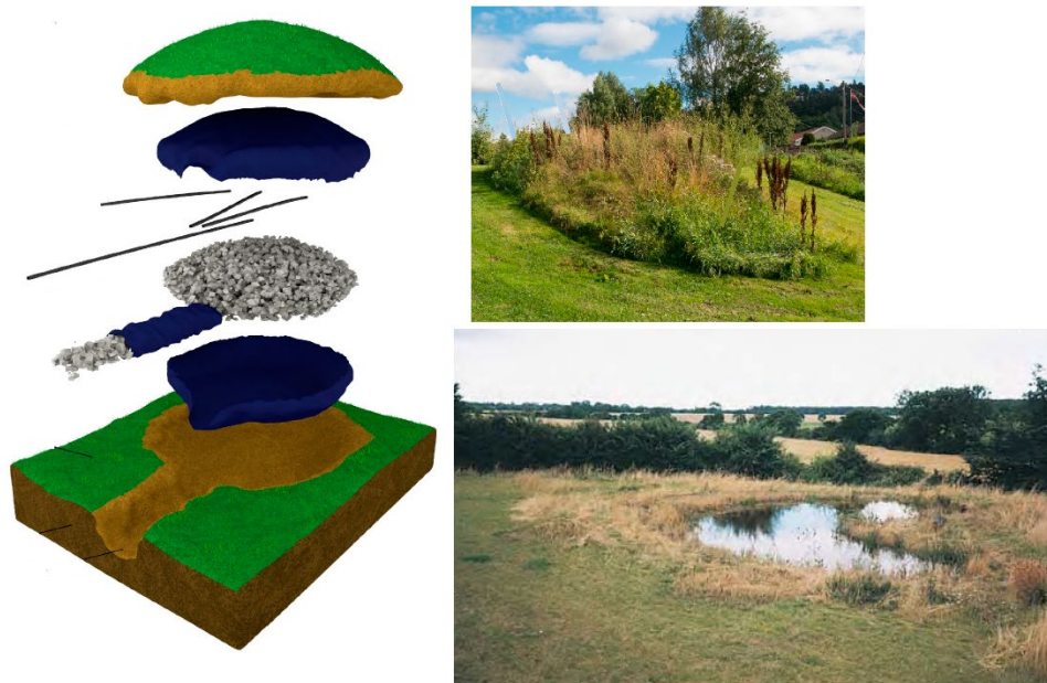
Figuur 7.4 Referentiefoto's van toe te passen elementen voor de kleine watersalamander. Links een 3D model van een overwinteringshotel, met stenen, drainagepijpen, grond en geotextiel (Dervo et al., 2018). Rechtsboven een gerealiseerd overwinteringshotel (Dervo et al., 2018). Rechtsonder: recent aangelegde poel (Langton et al., 2001).
